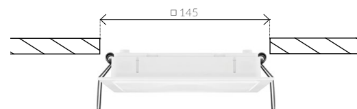
zestaw do montażu wpuszczanego option with recessed mount kit applied nr / no.: TM-AKC.MC.OR.01; EAN: 5902052564170
